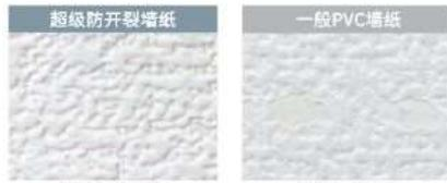
[测试方法] 基于日本墙纸工业协会规定的表面强化墙纸性能测试。
